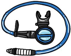
Pour les **détendeurs**, il est important de les rincer en **bouchant le 1er étage**. Il ne faut pas que l'eau stagne dans les détendeurs, plusieurs solutions s'offrent à vous : s'ils sont toujours connectés à la bouteille, faire fuser le détendeur pour éliminer l'eau, sinon tenir le détendeur verticalement avec le 2e étage orienté vers le bas, pour que l'eau s'écoule du détendeur.
