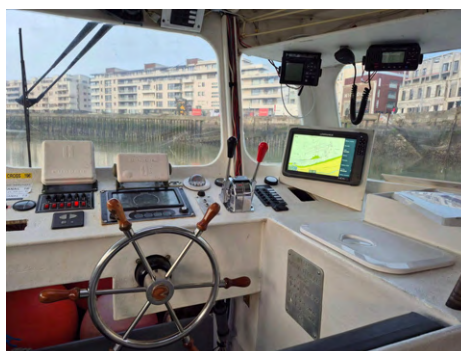
Mise en place d'une console pour sondeur et GPS
